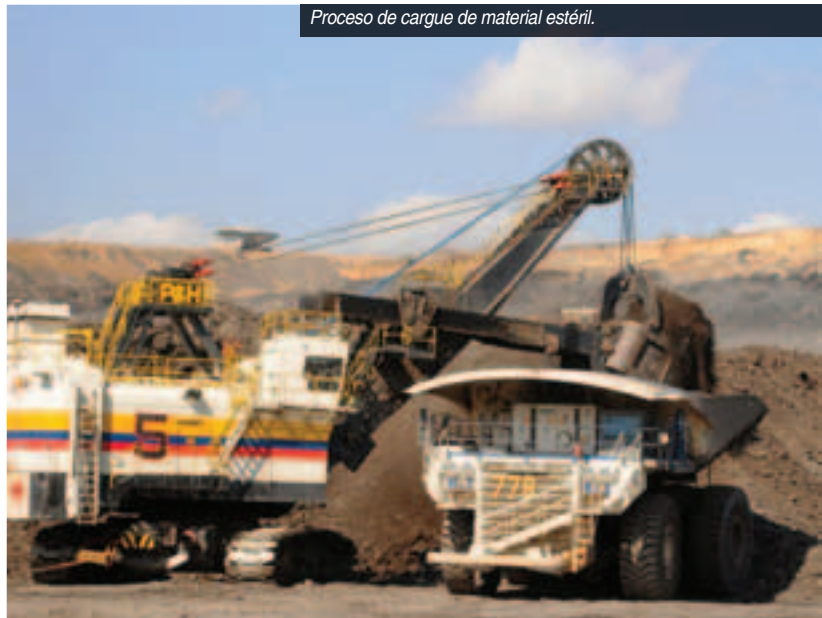
Proceso de cargue de material estéril.
