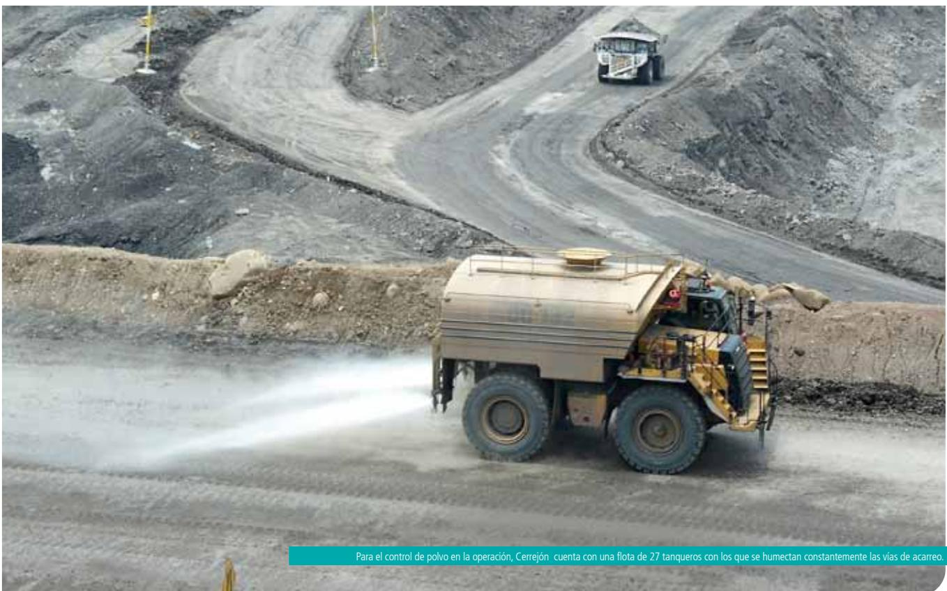
Para el control de polvo en la operación, Cerrejón cuenta con una flota de 27 tanqueros con los que se humectan constantemente las vías de acarreo.
