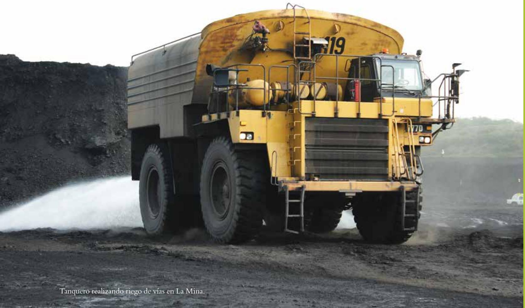
Tanquero realizando riego de vías en La Mina.
