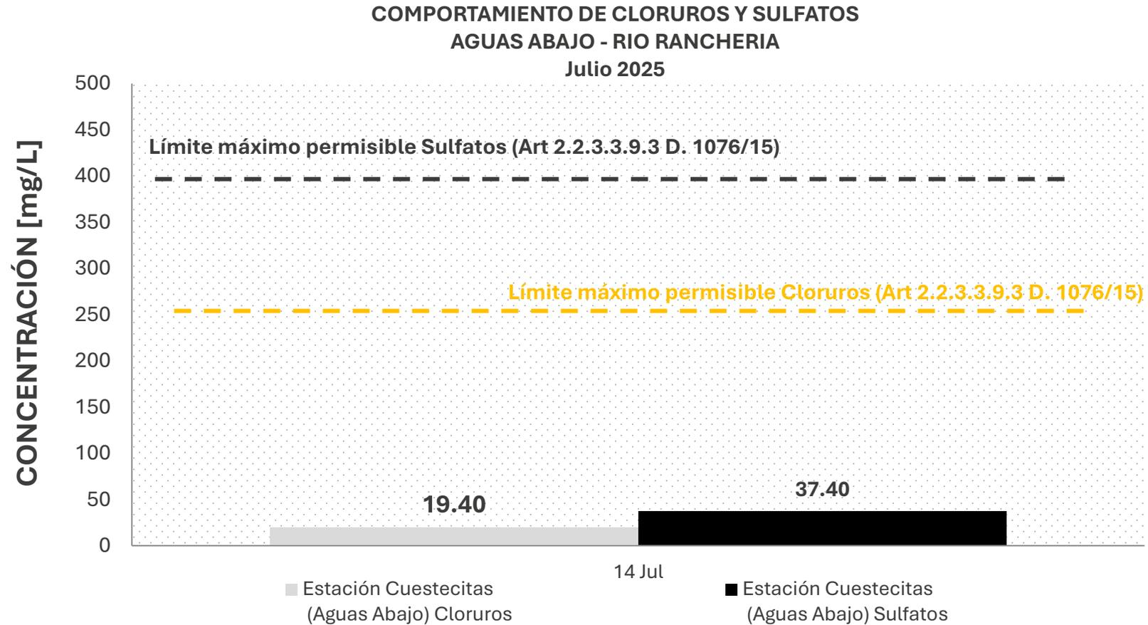
De acuerdo con nuestros monitoreos en el río Ranchería a la salida de la operación, se evidencia que la presencia de cloruros y sulfatos en el agua está muy por debajo de los límites establecidos por la norma de usos del agua en Colombia.
